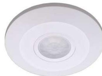
Détecteur de mouvement avec une sensibilité élevée . Utilise la source d'activation infrarouge quand vous entrez dans le champ de détection . Temps réglable et léger. Avec capteur crépusculaire . Minuteur intégré avec un minimum de 10 secondes à 7 minutes . Plage de détection 360° et une distance de 6 mètres max.
